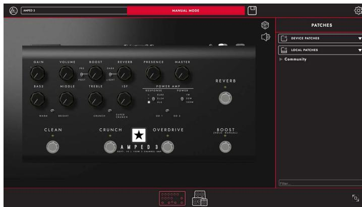
Auf dieser Seite können alle Bedienelemente auf der Oberseite (siehe Abschnitt „Oberseite“ in dieser Anleitung) des AMPED 3 eingestellt werden.
