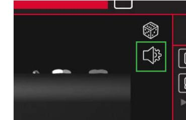
Cliquez sur l'icône des « réglages audio » pour ouvrir le panneau des réglages audio. Réglez ici le canal MIDI, la boucle d'effets (FX Loop) et la réverbération (Reverb). Les changements effectués ici entreront automatiquement en vigueur, mais ne seront pas enregistrés de façon permanente dans l'ampli. Pour les enregistrer, cliquez sur « Save Amp Settings » en bas de la page.
